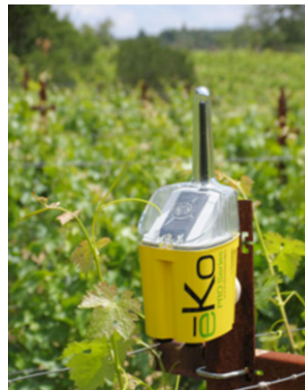
Control de las viñas haciendo uso de un dispositivo empotrado dotado de interfaz de comunicación inalámbrica
